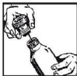
Dose durch Öffnen der Überwurfmutter entlüften.
