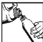
Sprühventil mit Steigrohr herausziehen. Flüssigkeit bis zur auf dem Etikett angegebenen Füllhöhe einfüllen.
