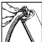
Dose mit Sprühventil **nach unten** halten und mit Druckluft mittels Kompressoranlage, Hand- oder Fußpumpe, befüllen (5-8 bar, je nach Inhaltsstoff).
