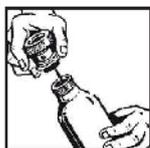
Steigrohr wieder einführen, Ventil mit Sprühkopf auf Gewindebund aufsetzen und mit Überwurfmutter handfest verschrauben.
